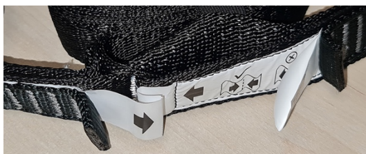
Abbildung 30: Überprüfung des Auslöse Indikators des Fangstoßdämpfers
