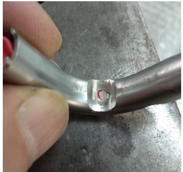
Abbildung 22: Durchgenutztes Abriebblech - muss erneuert werden
