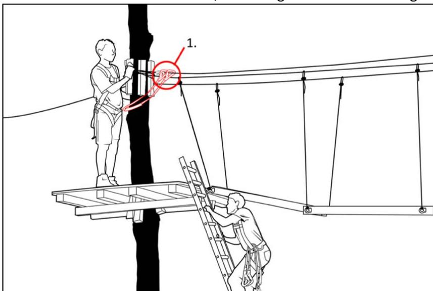
Abbildung 26: Benutzer mit beidseitig blockiertem System (Beta Fehler)
