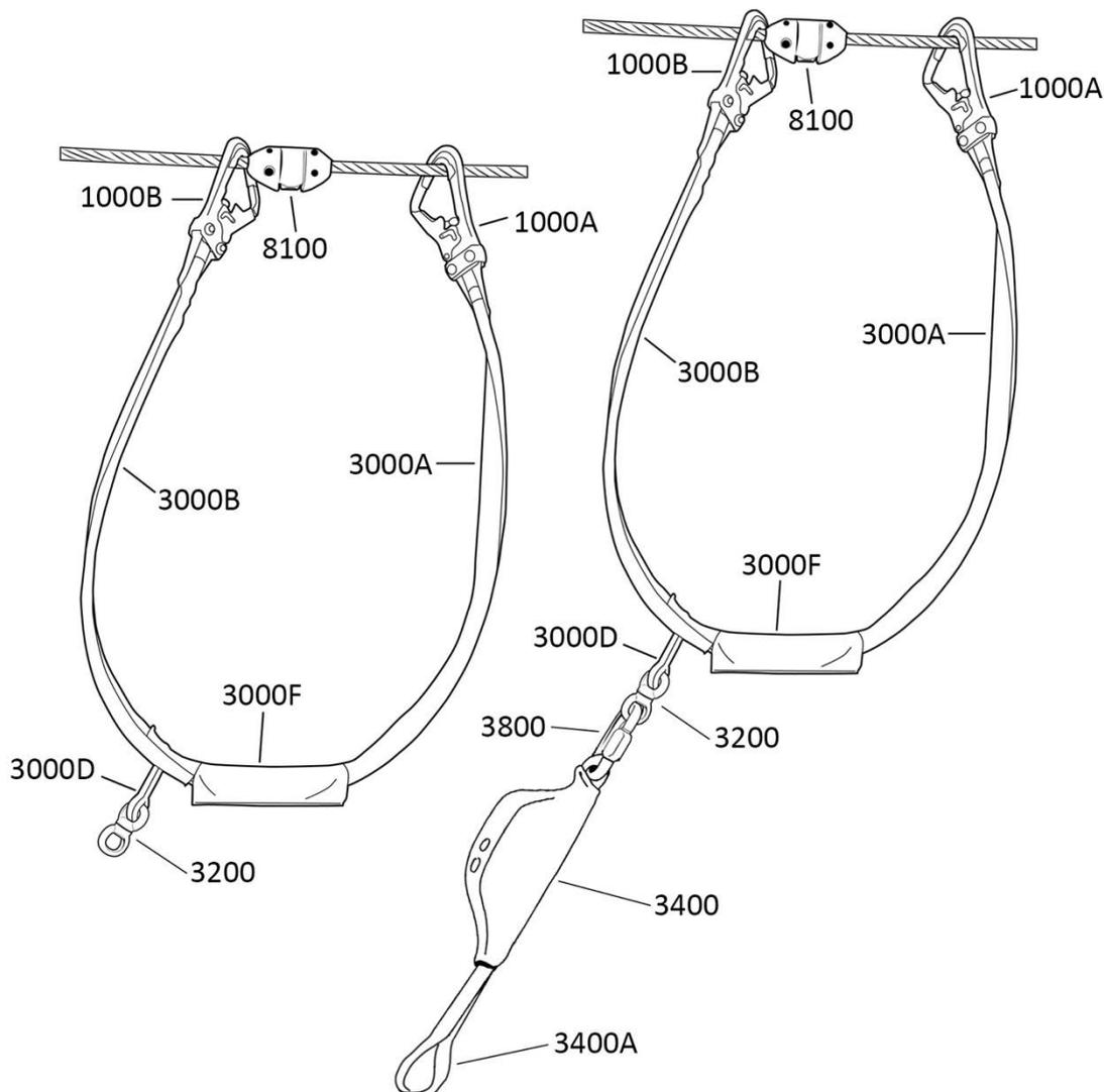
Abbildung 5: Gesamtsystem LockD Clips und LockD Clips ROCKS
