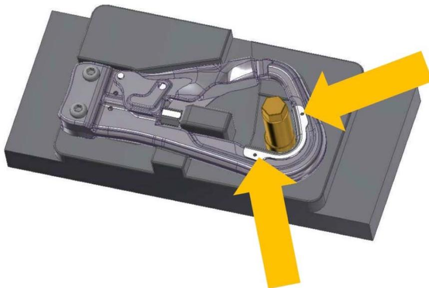
Abbildung 23: Platzieren des Karabinier Körpers im Montageblock
