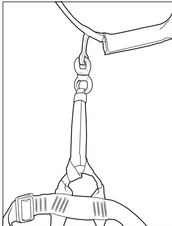
Abbildung 13: Verbindung mit Gurt Band im Ankerstich am eingenähtem Swivel
