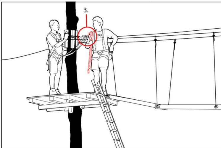
Abbildung 28: Benutzer wird vom defekten System entkoppelt
