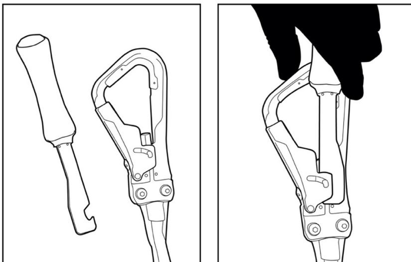
Abbildung 29: Verwendung des Rescue Bleches mit Arbeitshandschuhen
