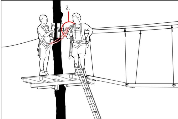
Abbildung 27: Ersatzsystem wird angebracht und Benutzer wird gesichert
