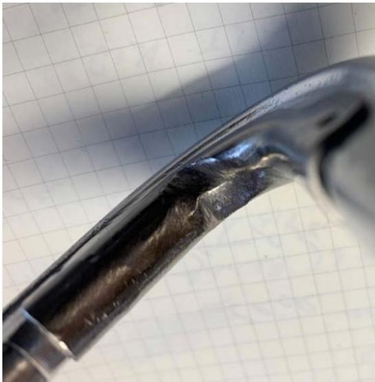
Abbildung 21: Leicht abgenutztes Abriebblech – muss nicht erneuert werden
