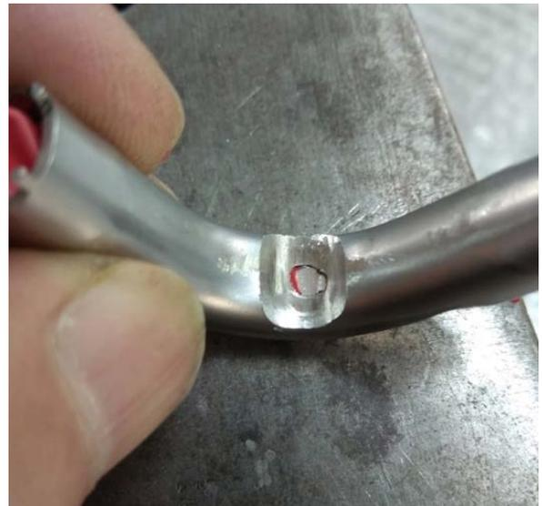
Abbildung 22: Durchgenutztes Abriebblech - muss erneuert werden
