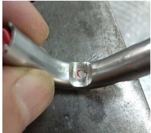
Abbildung 23: Durchgenutztes Abriebblech - muss erneuert werden
