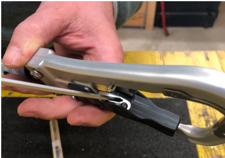
Abbildung 21: Befestigen und Verkleben der Schraube
