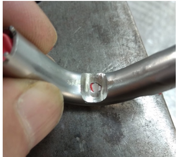
Abbildung 23: Durchgenutztes Abriebblech - muss erneuert werden
